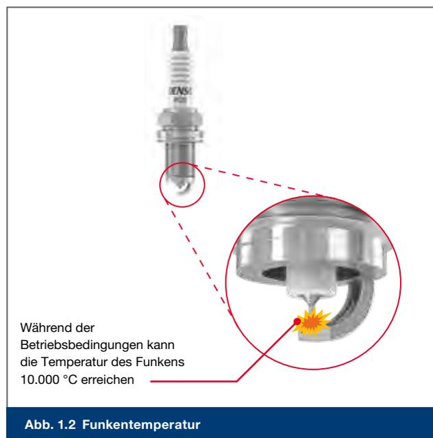
Diese anfängliche Verbrennung erzeugt dann eine heiße Flamme, die sich auf den Rest des Gemischs ausbreitet und somit eine Verbrennung im gesamten komprimierten Luft-/Kraftstoffgemisch im Brennraum erzeugt.
