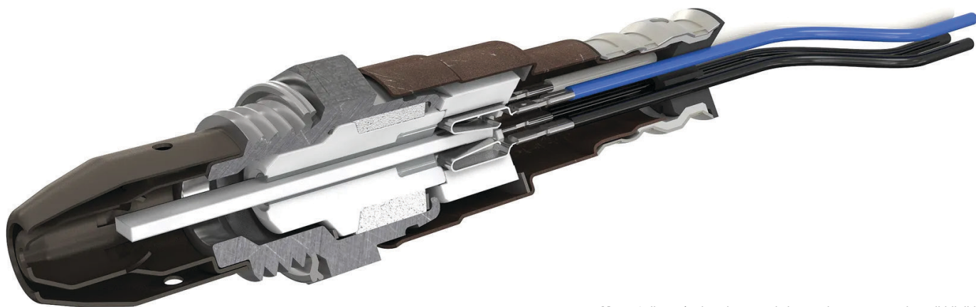
Kuva 1: ilman/polttoaineen suhdetta mittaavan anturin poikkileikkaus
