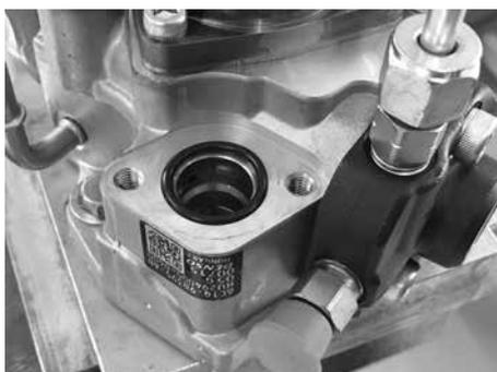
Einbau eines neuen O-Rings
