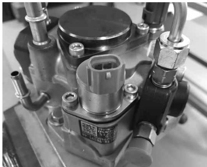
Installieren Sie das Saughubsteuerventil, indem Sie es vorsichtig in das Gehäuse drücken (um Beschädigungen des O-Rings zu vermeiden). Wenn das Saughubsteuerventil in Position ist, entfernen Sie die Führungsstifte.
