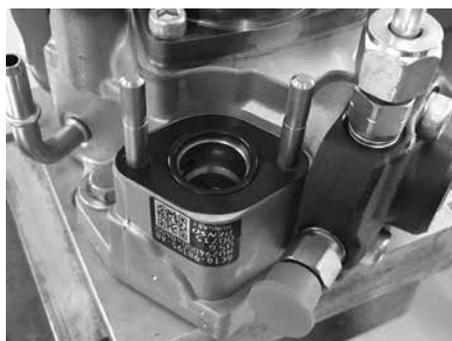
Zwei Führungsstifte in die Befestigungslöcher einsetzen und die neuen Dichtungen montieren
