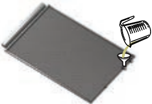
Füllen Sie 40 cc durch den Kondensator
