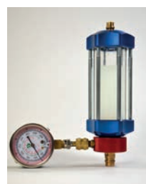
Kältemittel R134a gemischt mit - DENSO ND8 (PAG46) - DENSO ND11 (POE-Isolationsöl)
