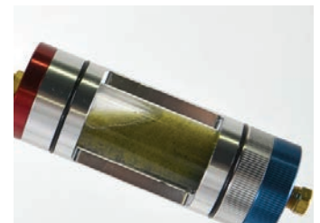
Gummiabrieb im Klimasystem
