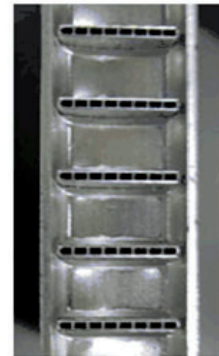
Querschnitt durch die Kondensatorrohre
