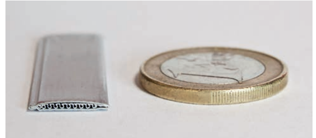
Ein Vergleich mit einer 1-Euro-Münze veranschaulicht die Größe der winzigen Kondensator-Kühlkapillare.
