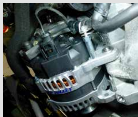
Kabel akumulatora i okablowanie złącza montuje się bez problemu
