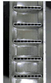
Querschnitt durch die Kondensatorrohre
