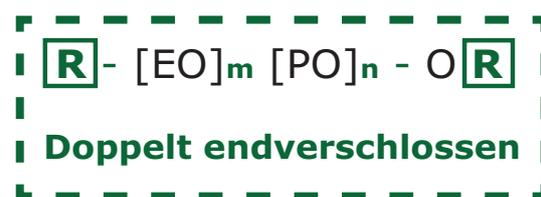
Doppelt endverschlossen im Vergleich zu einfach endverschlossen
