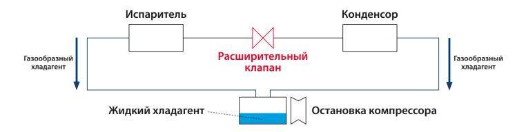
Компрессор обладает высокой теплоемкостью. Поэтому, когда транспортное средство находится на стоянке в течение длительного времени, газообразный хладагент охлаждается компрессором, становится жидким и накапливается. При повышении температуры окружающей среды компрессор нагревается труднее, чем другие компоненты системы. В результате возникают случаи, когда жидкий хладагент не превращается в газообразный и накапливается в компрессоре. Вот почему используется контрольный клапан с функцией CS.
