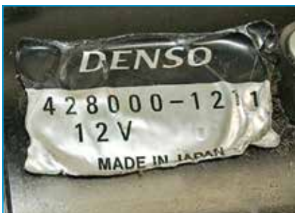
Ідентифікаційна етикетка перегрілась і зменшилась у розмірах. Це свідчить про вплив надміру високої температури.
