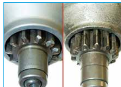
Нормальний стартер (зліва), шестірня обгінної муфти повністю втягнута. Перегрів стартер (справа), шестірня обгінної муфти втягнута не повністю. Перегрів впливає на пружність зворотної пружини.
