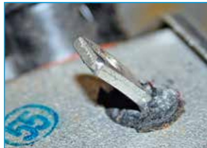
Пошкодження клем може призвести до замикання маси на корпус.
