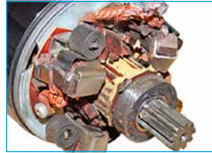
Пошкодження комутатора, щіток і тримача щіток у зборі.
