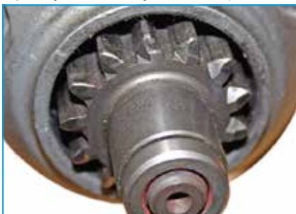
Повторне зачеплення з незначними наслідками (наслідки — пошкодження маховика і труднощі під час зачеплення з маховиком).
