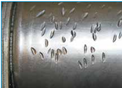
Кришка соленоїда зазнала численних ударів молотком або іншим стороннім предметом.
