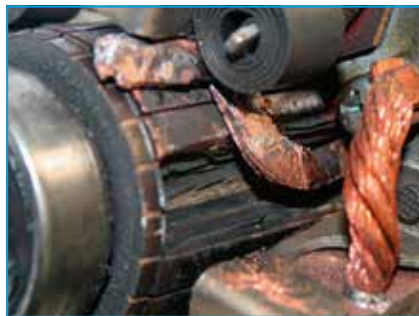
Поверхня комутатора вкрита нальотом. Пластини комутатора вигнуті.
