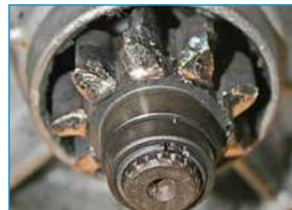
Повторне зачеплення шестірні з серйозними наслідками.
