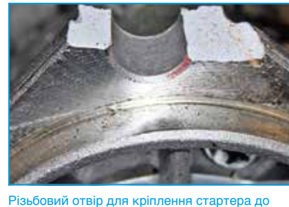
Різьбовий отвір для кріплення стартера до двигуна за допомогою болтів пошкоджений внаслідок неправильного поводження, неправильного встановлення або затягування болта двигуна із надмірним зусиллям.
