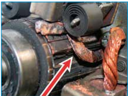
Пластина комутатора відокремлена, піднята і вигнута (деформована).
